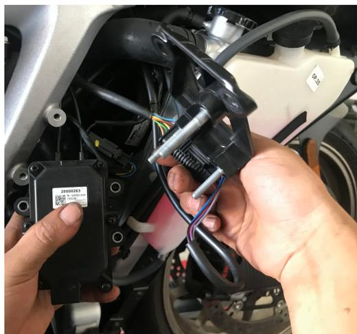
Scollegare il connettore elettrico dell'attuatore della valvola.
