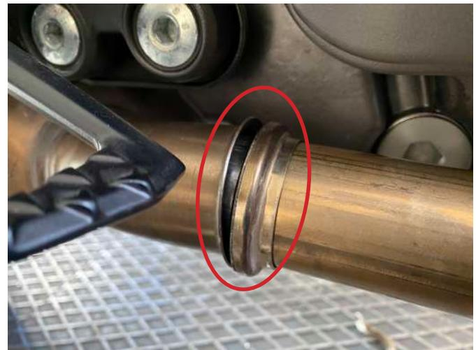
**PER FACILITARE LA RIMOZIONE DEL COLLETTORE PRIMARIO, ALLENTARE LEGGERMENTE LE FASCIETTE E I BULLONI DEL COLLETTORE ORIGINALE**
