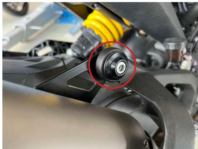
**2. Installare le mollette per le viti del paracalore e successivamente fissare il carter originale sullo slip-on spark utilizzando le viti originali**
