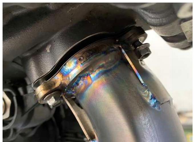
**4. Stringere la sonda lambda e la fascetta originale (controllare che l'anello in grafite sia in posizione).**
