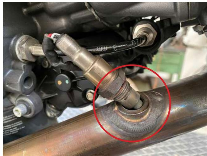
**2. Rimuovere la fascetta originale dal collettore primario ed allentare leggermente i bulloni e le fascette del catalizzatore originale così da agevolare la rimozione del collettore primario**
