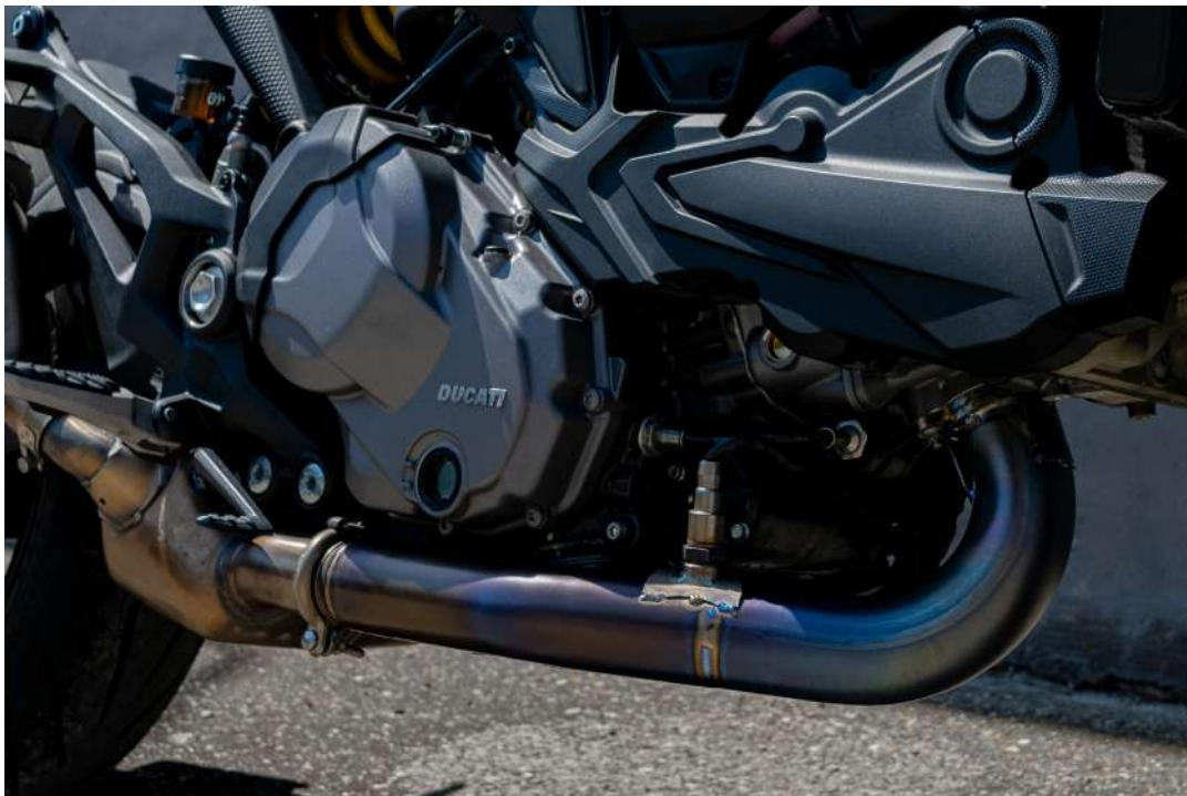
**1. Rimuovere il collettore primario originale svitando i 3 bulloni originali e la sonda lambda.**
