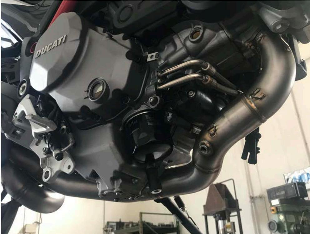
2. Avvitare i 3 dadi del collettore frontale al cilindro, poi stringere la fascetta del collettore al cilindro verticale.
