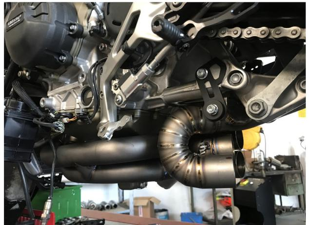
**4. Avvitare la staffa non stringendola completamente in modo da non complicare il montaggio.**
