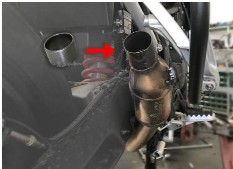
2. Posizionare il silenziatore Spark utilizzando la fascetta in dotazione. Fissare la staffa silenziatore al telaio utilizzando la vite originale e il dado, poi stringere tutte le viti.
