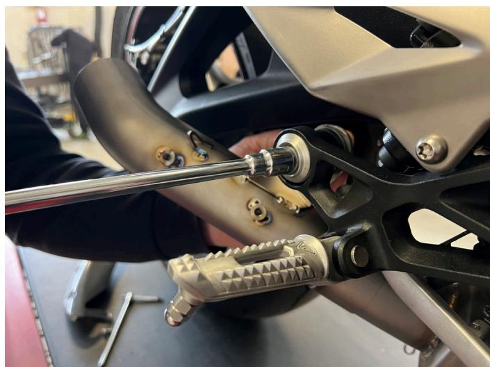
**8. Fissare il paracalore in carbonio con le viti in dotazione.**
