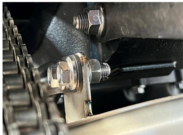
**4. Inserire il raccordo nel box e inserire la vite nell'alloggio originale senza stringerla.**
